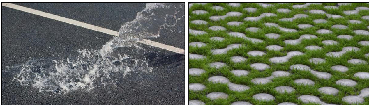
Figura 6-4: Esempi di pavimentazioni permeabili continue e discontinue
