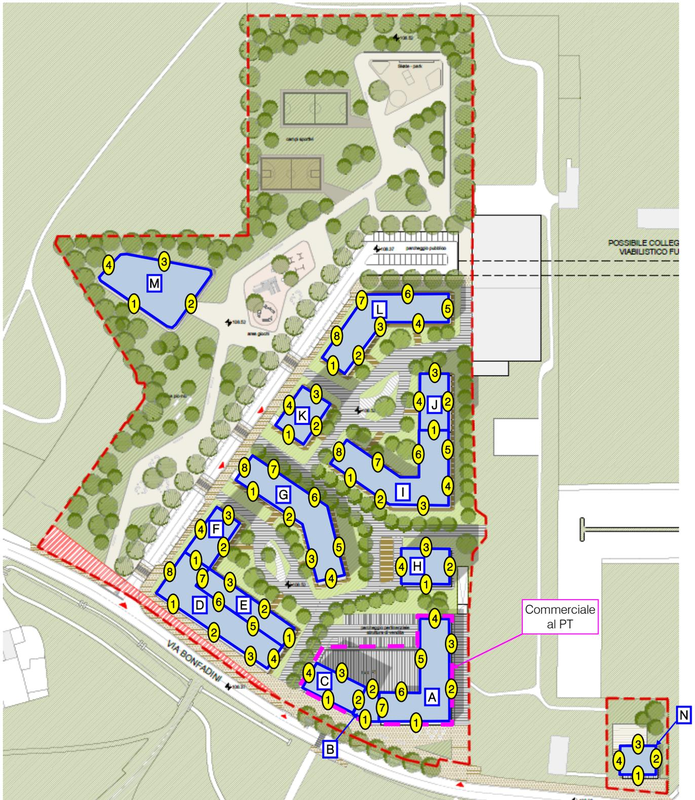
Fig.08 – Planimetria area di progetto, denominazione edifici (blu) e numerazione punti recettore (giallo).
