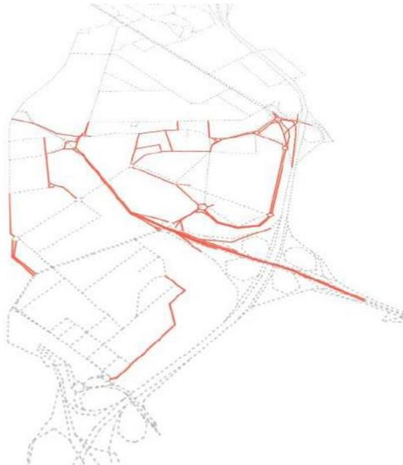
Figura 165 Grafo della rete utilizzato per il modello, in rosso gli assi di futura realizzazione o potenziamento.
