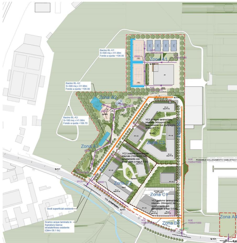
Figura 30 Schema di gestione delle acque relativo all'invarianza idraulica.
