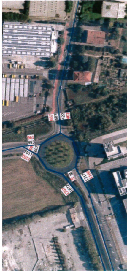
Figura 30 – Rotatoria 2: raffronto tra flussi rilevati (in rosso) e flussi simulati (in blu) – ora di punta del mattino
