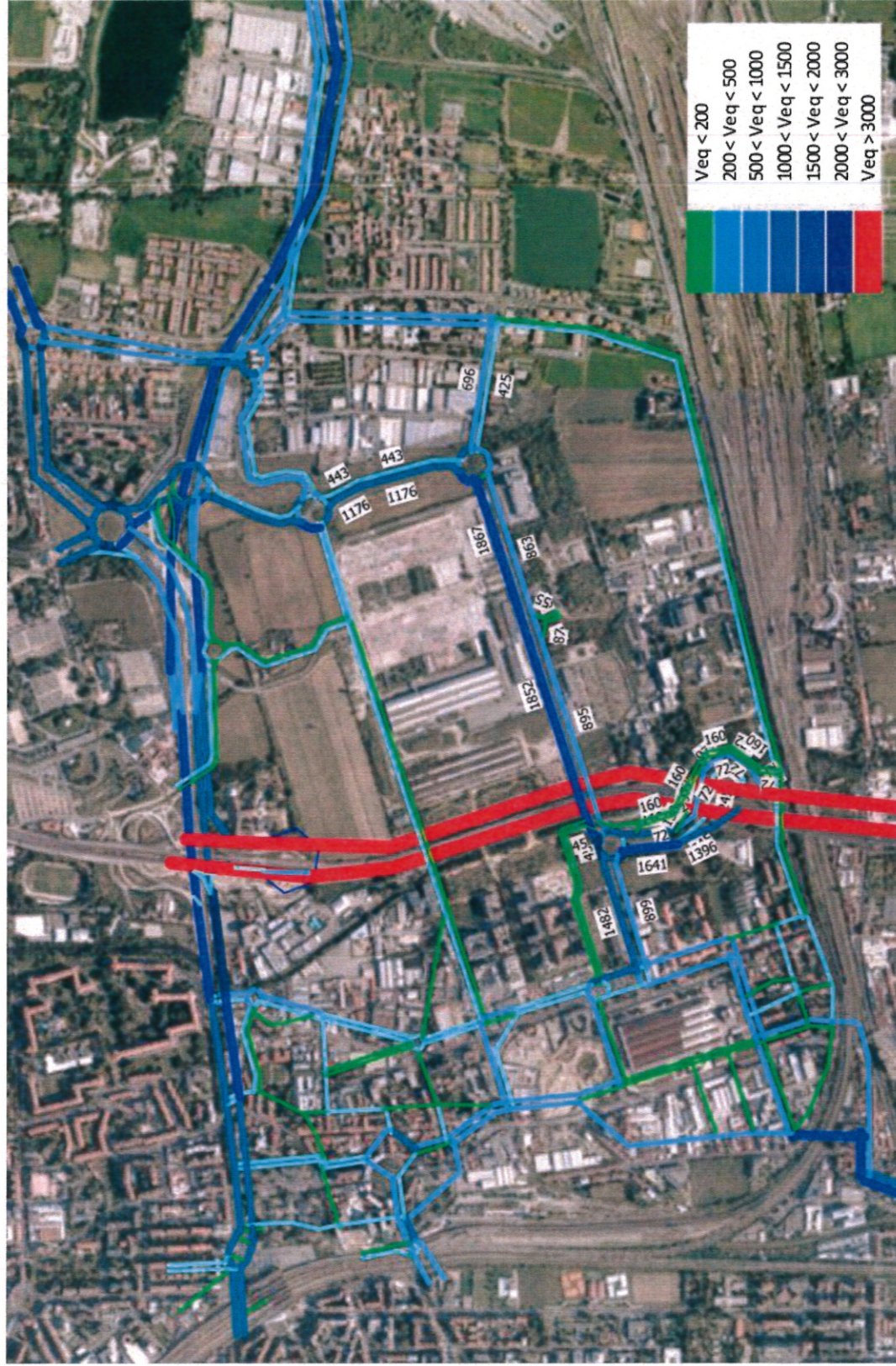
Figura 53 – Scenario di intervento, ora di punta del mattino – Flussogramma area di studio
