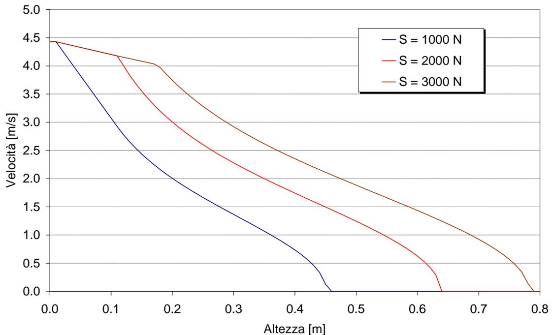
Figura 5.4- Combinazione delle condizioni di spinta ed energia (per  $E = 1.0 \text{ m}$ )
