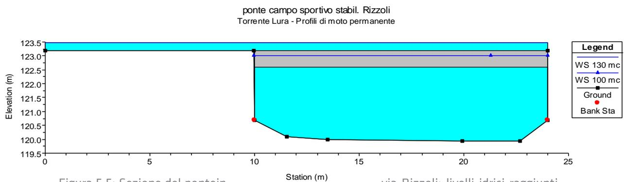
Figura 5.5: Sezione del ponte in via Rizzoli: livelli idrici raggiunti per portate di 100 e  $130 \text{ m}^3/\text{s}$ .
